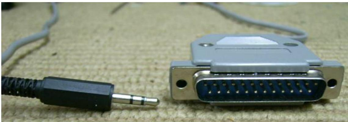
**Se basa casi en lo mismo tenemos el Diodo en el conector 3.5mm pero colocamos del otro lado un DB25 para hacerlo compatible con nuestros cables de programación originales**
