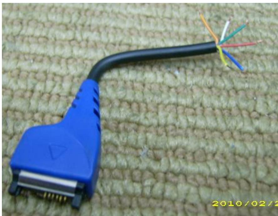
Antes que nada les comento este cable que pongo de ejemplo es un cable CA-42 del fabricante "MOSS" los colores cambian de un fabricante a otro. Pero podemos identificar las puntas puesto que la posición de datos en el celular es la misma
